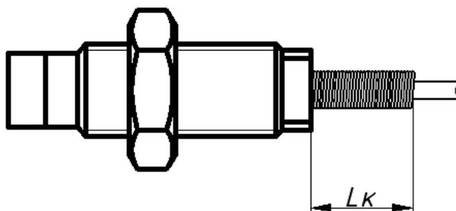
**L<sub>к</sub>** – длина кабеля датчика в металлорукаве без узла уплотнения, м. макс. длина кабеля датчика 10 м;
