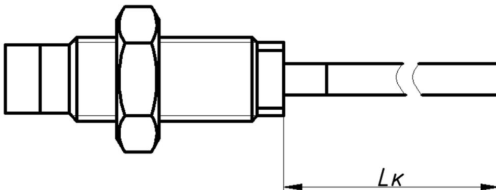
**L<sub>к</sub>** – длина кабеля датчика без металлорукава, макс. длина кабеля датчика до 10 м.;
